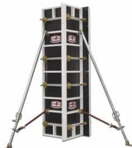
Grâce au pince angle externe et les éléments standards, il est possible de composer des poteaux de différentes dimensions. En respectant la pression maximum de coulage, il est possible de réaliser des compositions sans aucune contrainte de hauteur.
