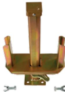
Tête de décoffrage H20 – blocable avec deux boulons sur l'étais EN 1065, fonctionnant avec deux poutrelles H20 primaires et secondaires, il permet le décoffrage partiel anticipé ou bien récupération de H20 et 75% des panneaux coffrantes, laissant les étais et les têtes de décoffrage à l'appui de la dalle.
