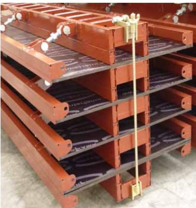
Die Schalungsplatte 18 mm ist aus finnischen Birkenfurnieren 11-fach verleimt und die Oberfläche mit Phenolharzfilm 220 g/m<sup>2</sup> (2) versiegelt.
