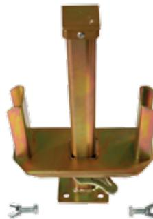
Schnellabsenkkopf H20 kann auf alle EN1065 Stützen mit zwei Schrauben befestigt werden und erlaubt das Einlegen von zwei Holzträgern. Durch das vorzeitige Absenken vom Stützenkopf wird ein frühzeitiges Ausschalen ermöglicht. Dadurch können die Holzträger und 75 % der Schaltafeln nach 2 - 5 Tagen wiederverwendet werden.
