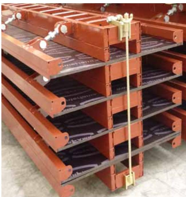
La surface de contact avec le béton est faite avec contreplaqué de bouleau finlandais épaisseur de 18 mm (2), avec revêtement phénolique 220 g/m<sup>2</sup>, en variante, avec une surface de polypropylène de 1,6 mm.
