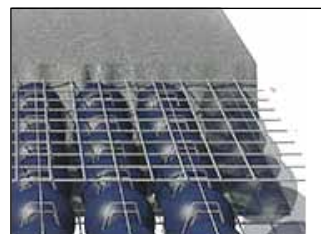
Solaio getto pieno alleggerito
